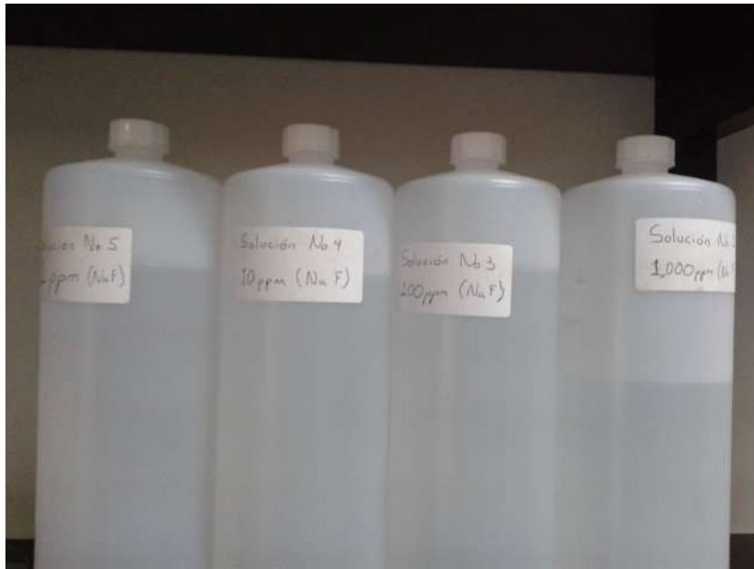
Figura 11. Soluciones de fluoruro utilizadas a concentraciones de 1, 10, 100 y 1000 ppm.
