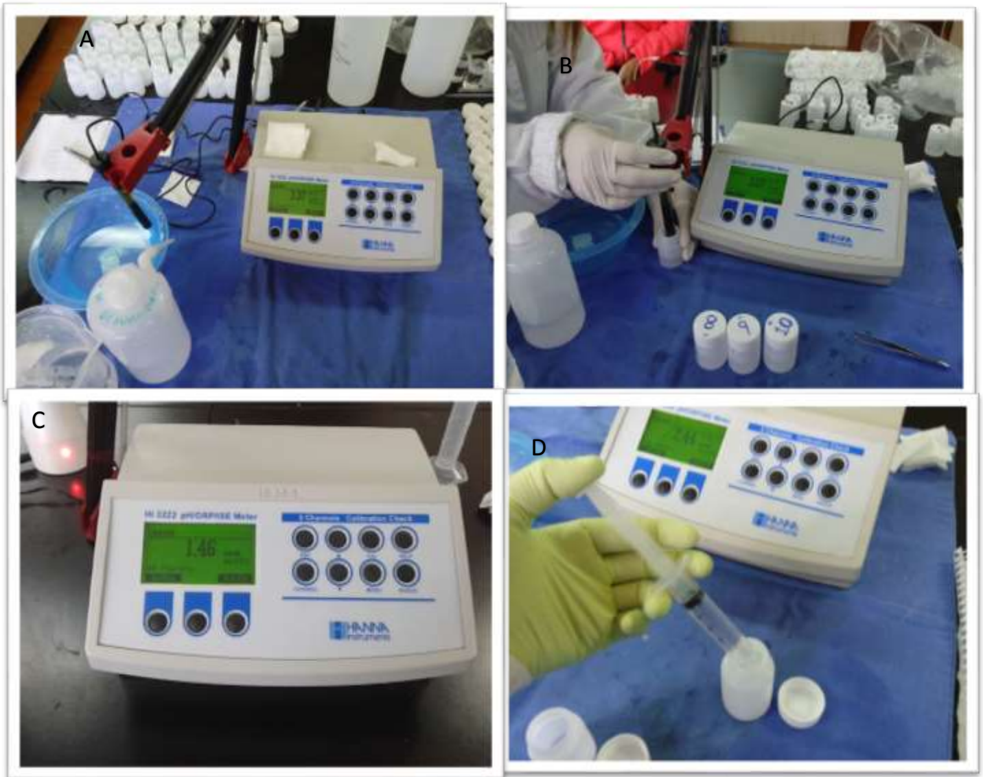
Figura 13. A) potenciómetro calibrado, B) medición de la muestra, C) fluoruro liberado en partes por millón y D) colocación de la muestra en un nuevo recipiente colocando 5ml de agua desionizada.
